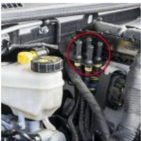
13700001 Aération de boîte de vitesses pour profondeur de gué plus élevée, boîte de vitesses mécanique 238,00
