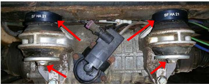
Hinterachsdifferential mittels der Distanzscheiben SFHA15 (1x vorne) und SFHA21 (2x hinten) und den mitgelieferten Schrauben absenken, Anzugsmoment 65 Nm.
