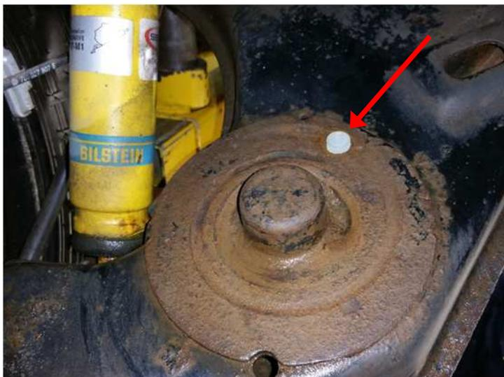
Stoßdämpfer und Fahrwerksfedern an der Hinterachse laut VW Angaben wechseln. Darauf achten, dass der Schraubenschaft der oberen Stoßdämpferaufnahme gefettet ist. Mitgelieferte Feder-Unterlage oben zwischen Feder und Karosserieauflage verbauen. Bei langem Radstand jeweils zwei Distanzscheiben verbauen.
