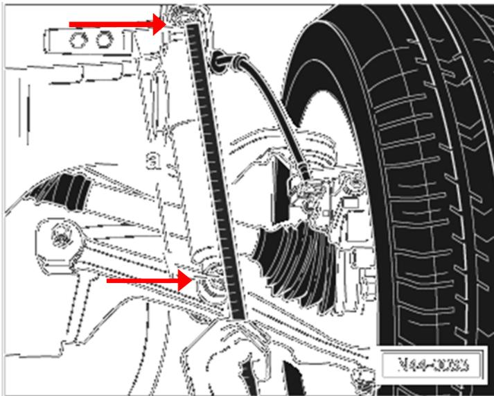
Fahrzeughöhe vorn durch Drehen der Einstellschrauben der Drehstabfedern auf 1° Karosserineigung nach vorn bzw. max. 275 mm von Schraubenmitte der Dämpferaufnahme oben bis Schraubenmitte Dämpferschraube unten einstellen. Siehe dazu auch VW Reparaturanweisung.
