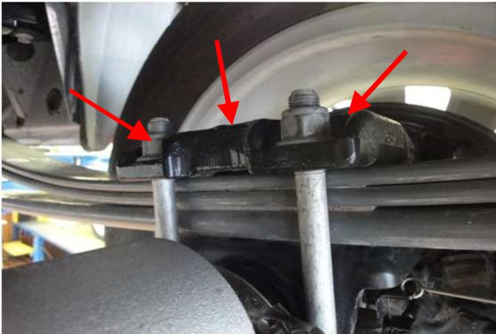
Rad abbauen und Hinterachse mit Heber abstützen. Stoßdämpfer unten abschrauben, vier Muttern an Federbügel abschrauben und Federspannplatte von der Blattfeder entnehmen.
