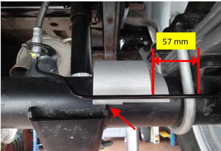
Anschlagverlängerung auf Hinterachsrohr auflegen und laut Bild am Achsanschlag ausrichten. Anschlagverlängerung muss unbedingt ganzflächig auf dem Achskörper aufliegen. Ggf. mit Werkstattmitteln nacharbeiten.
