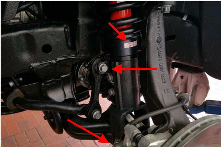
Stabilisator am Federbein und Klemmschraube am Stoßdämpfer unten nach Werksangaben festziehen.
