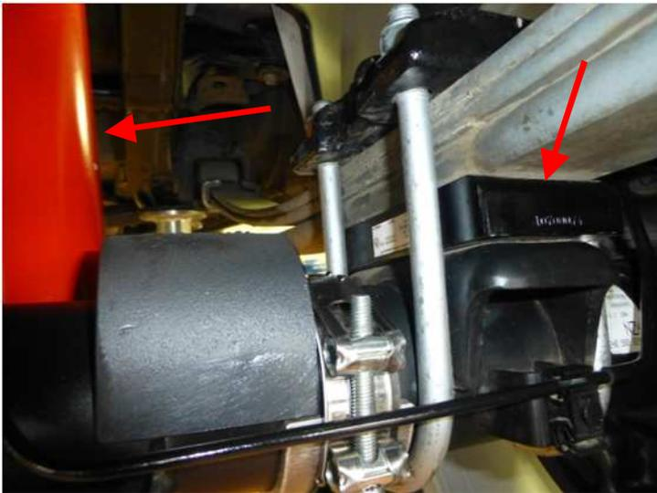
Achse absenken und Distanzklotz von 25 mm mit Rundung nach oben unterlegen. Achse anheben und auf richtigen Sitz der Führungsbolzen achten. Achse, Blattfeder und Federspannplatte mit mitgelieferten neuen Federbügel und Muttern verschrauben. Stoßdämpfer austauschen. Anziehdrehmoment laut Werksangaben.
