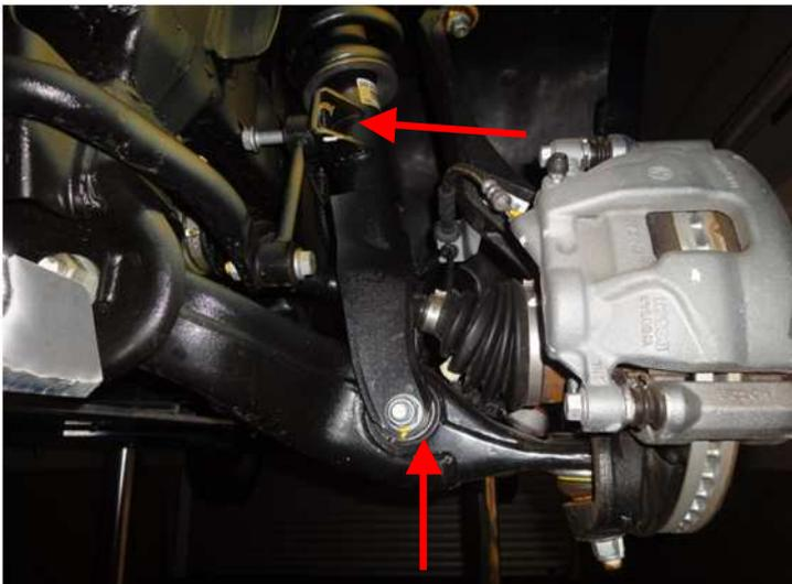
Stabilisator am Federbein und Klemmschraube am Stoßdämpfer unten lösen, Federbein komplett herausheben.
