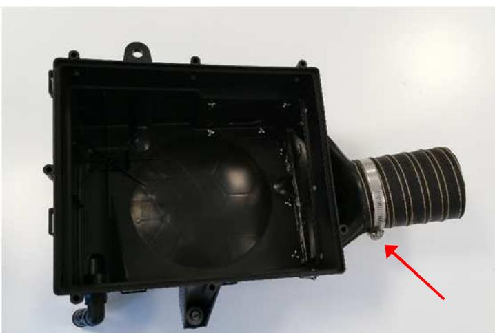
Schlauchstutzen mit mitgelieferter Schelle an unterem Luftfiltergehäuse befestigen.
