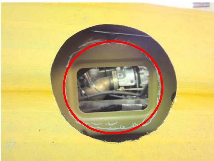
Durch den Kotflügeldurchbruch an der Kante entlang mit einem Stift die Vergrößerung an der Motorraumtrennwand anzeichnen und abtrennen.
