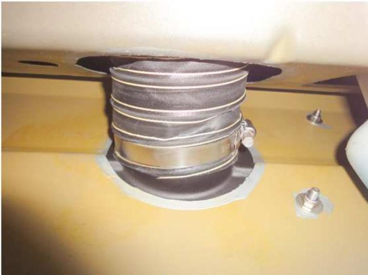
Luftfiltergehäuse durch die ausgefräste Öffnung zum Snorkelrohr positionieren, Schlauchstutzen scheuerfrei verlegen und am Snorkelrohr mittels Schlauchschelle befestigen.
