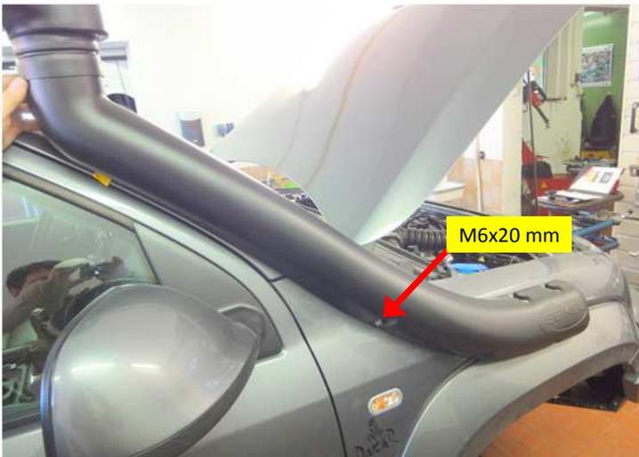
Snorkelrohr mit 3x M6x20 und 1x M6x30 mit U-Scheiben und Muttern an Kotflügel ausrichten. Beide noch fehlenden Schrauben M6x20 mm in die Einnietmutter eindrehen, Snorkelrohr am A-Holm ausrichten und beide oberen Schrauben festziehen.
