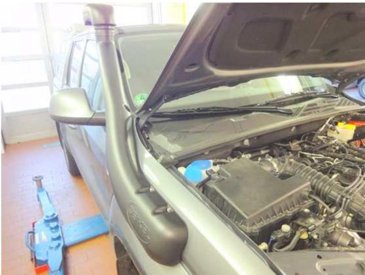
Beide Luftfiltergehäuse befestigen, alle Schlauchverbindungen an ihren originalen Punkten wieder einhängen und das Radhaus rechts wieder komplettieren
