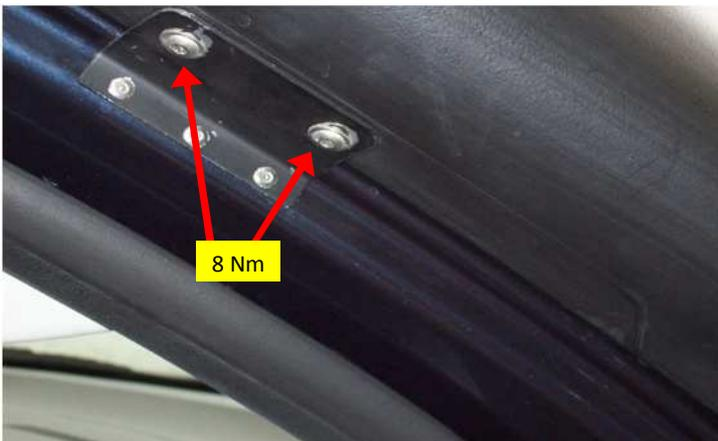
Halter mit dem Rohr verschrauben, Schrauben noch nicht endgültig festziehen. Halter entlang der A-Säule ausrichten und drei 3,2mm Bohrungen für die Bechernieten in die A-Säule einbringen. Bohrungen mit Rostschutzmittel konservieren!
