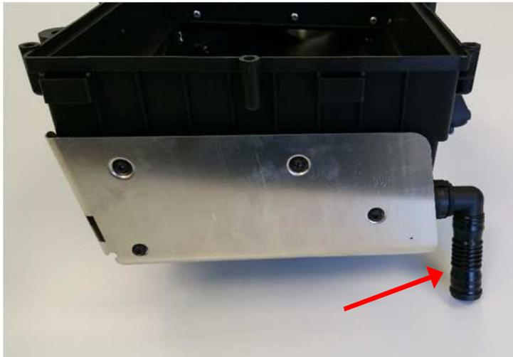
Wasserablaufschlauch auf mitgeliefertes unteres Luftfiltergehäuse umstecken.
