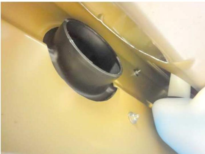
Alle 4 unteren Schrauben mit Muttern und Unterlegscheiben von innen befestigen.
