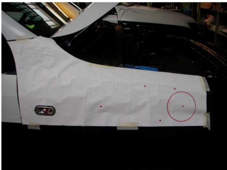
Mitgelieferte Bohrschablone an Kotflügel anlegen, und an den Konturen des Kotflügel ausrichten und befestigen.
