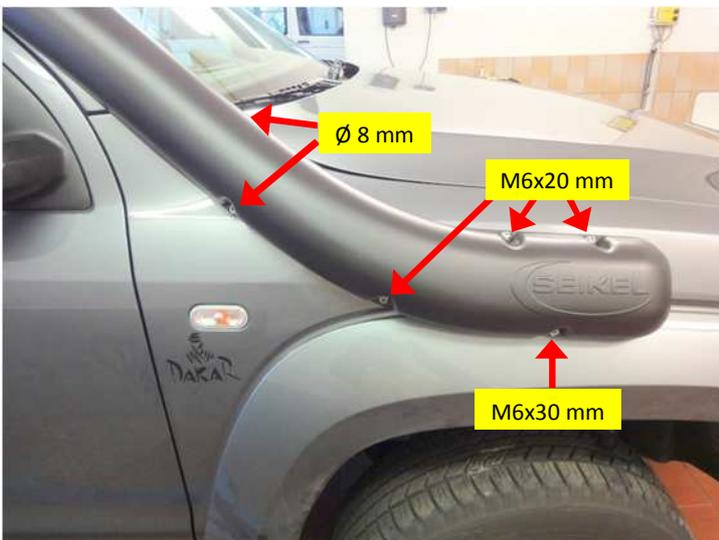
Snorkelrohr mit 3x M6x20 und 1x M6x30 mit U-Scheiben und Muttern an Kotflügel ausrichten und provisorisch befestigen. Beide noch fehlenden Bohrungen bei fest anliegendem Snorkelrohr anzeichnen und Snorkelrohr wieder entfernen.
