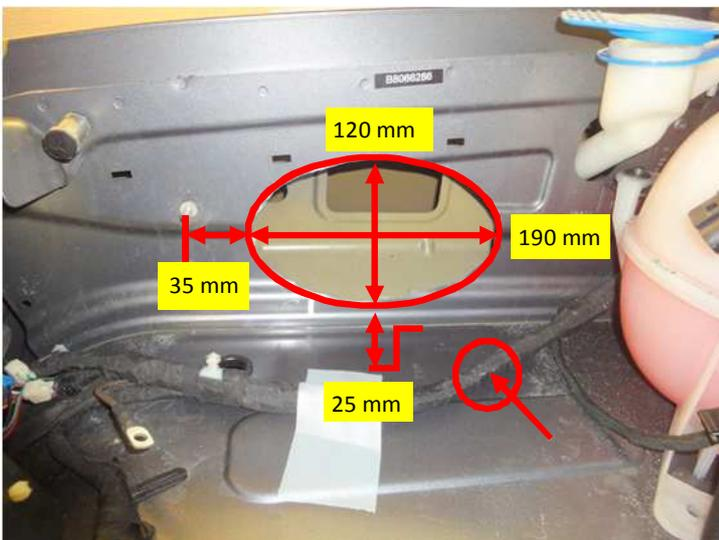
Ausschnitt laut Bild anzeichnen und mit Lochsäge ausschneiden. Überflüssigen Kabelstranghalter (Pfeil) entfernen. Alle Kanten entgraten, Bohr- und Schneidspäne entfernen und Schnittkanten gegen Rost behandeln.
