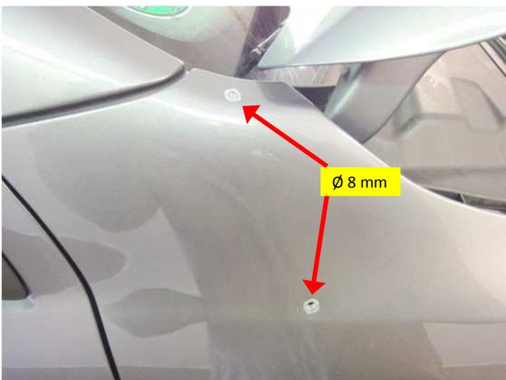
Snorkelrohr abnehmen, angezeichnete Löcher auf 8 mm aufbohren und 2 Einnietmuttern M6 mit Nietmutterzange einsetzen.
