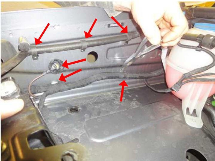
Kabelstrang, Masseband sowie Wasserschlauch im Motorraum rechts lösen und zur Seite legen.
